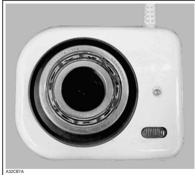
**ATTENTION:** Ne pas chauffer les roulements à plus de 80°C (176°F). Ne pas chauffer avec une flamme, un pistolet thermique ou de l'huile chauffée. Le joint interne pourrait être endommagé si on ne chauffe pas adéquatement les roulements.
