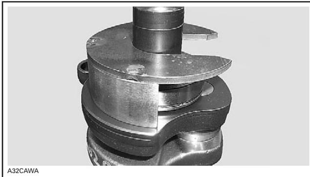
Glisser le roulement extérieur côté PDM chauffé sur le vilebrequin.
