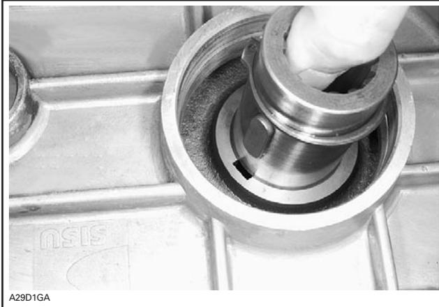
Appliquer de la graisse synthétique (N/P 413 711 500) sur les joints toriques des arbres intermédiaires. Installer les pignons intermédiaires n° 29 de manière que leur épaulement soit orienté vers la gauche. Placer les entretoises n° 28 tel qu'illustré dans la marche à suivre de dépose. Placer le côté biseauté des entretoises contre la paroi de la boîte de vitesses.
