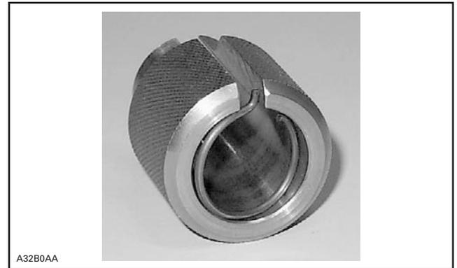
Avec l'extrémité ronde du poussoir, placer le circlip perpendiculairement à l'axe du support.
