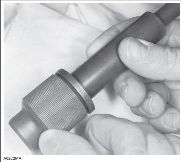
Appuyer sur le circlip avec le bout carré de l'outil jusqu'à ce qu'il s'assoit dans la rainure.
