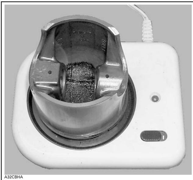
**ATTENTION:** Ne pas chauffer le piston à plus de 46°C (115°F). Ne pas chauffer avec une flamme et ne pas refroidir l'axe de piston. Le piston pourrait être endommagé s'il n'est pas chauffé adéquatement.
