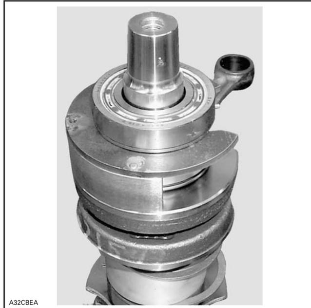
Installer le roulement côté MAG chauffé.
