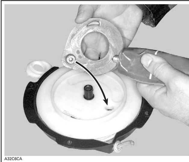
Lubrifier l'arrêt de cliquet n° 9 avec du Molykote PG 54 (N/P 420 899 763). L'installer par-dessus le cliquet.
