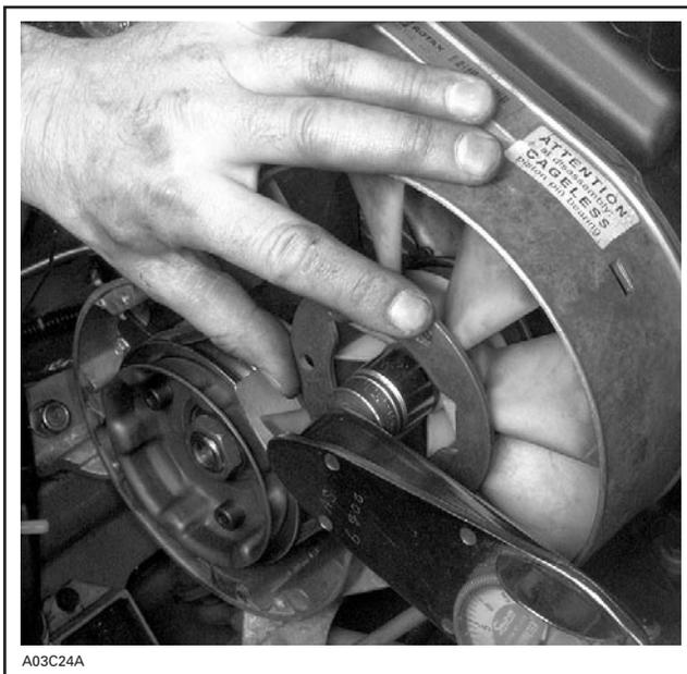
**SERRER L'ÉCROU DU VENTILATEUR AVEC LA CLÉ DE RETENUE**
