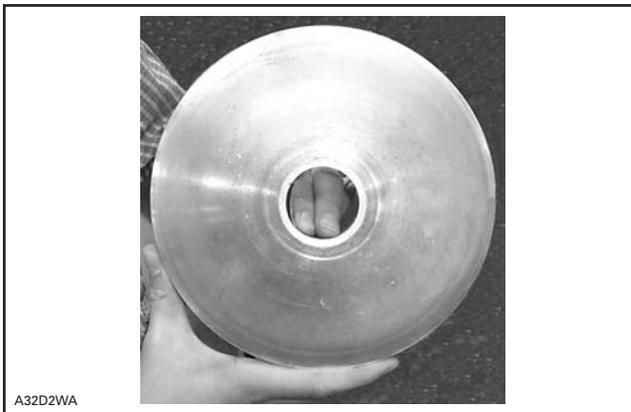
Avec du nettoyant pour flasques de poulie (N/P 413 711 809), nettoyer les surfaces de la demi-poulie où le coussinet doit être installé.
