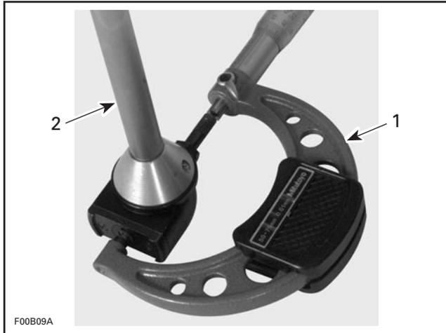
1. Utiliser le micromètre pour régler la jauge d'alésage de cylindre
