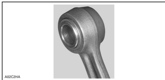
TYPIQUE — ROULEMENT À AIGUILLES SANS CAGE ET MANCHON INSTALLÉS
