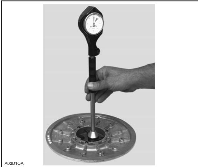
Remplacer les coussinets si leur diamètre est plus grand que la limite d'usure prescrite.
