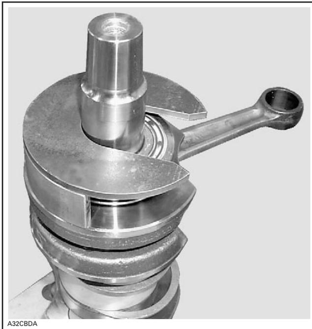
Glisser le roulement extérieur côté PDM chauffé sur le vilebrequin.
