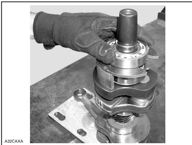
Installer le roulement côté MAG chauffé.
