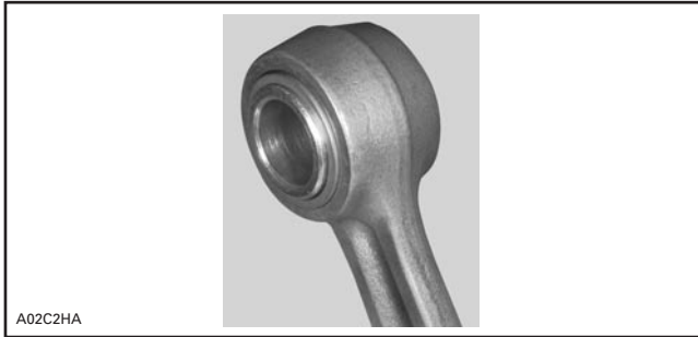
TYPIQUE — ROULEMENT À AIGUILLES SANS CAGE ET MANCHON INSTALLÉS
