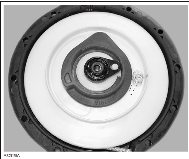
BOUT DE CORDE INSÉRÉ DANS LA POULIE
