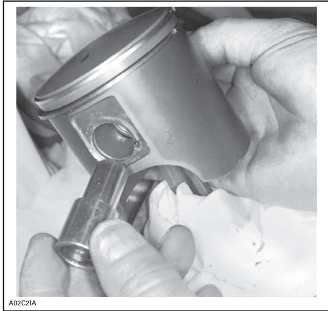
TYPIQUE — INSTALLATION DU MANCHON À ÉPAULEMENT
