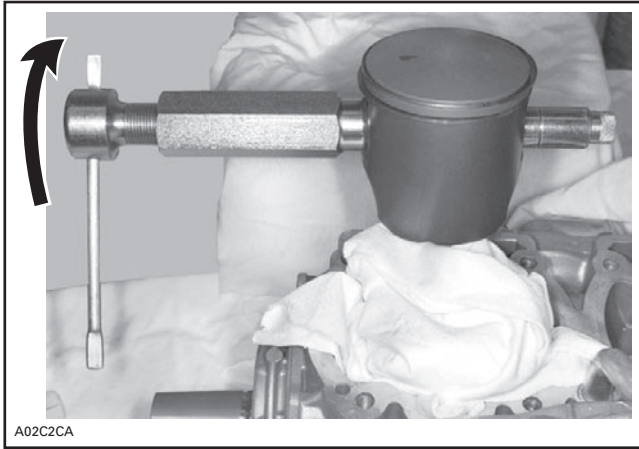
TYPIQUE — EXTRACTION DE L'AXE DE PISTON
