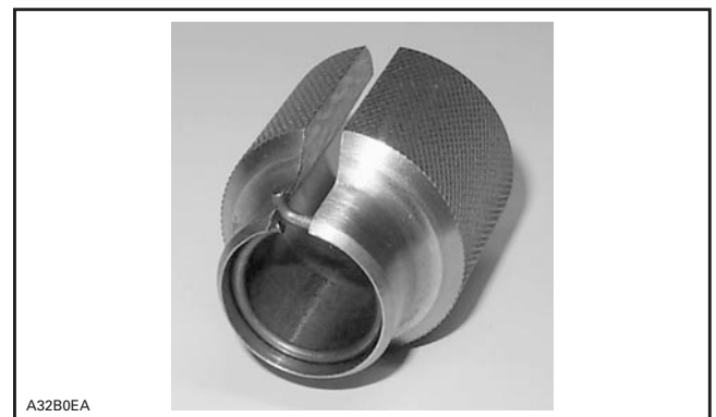
CIRCLIP PRÊT À ÊTRE INSTALLÉ SUR LE PISTON
