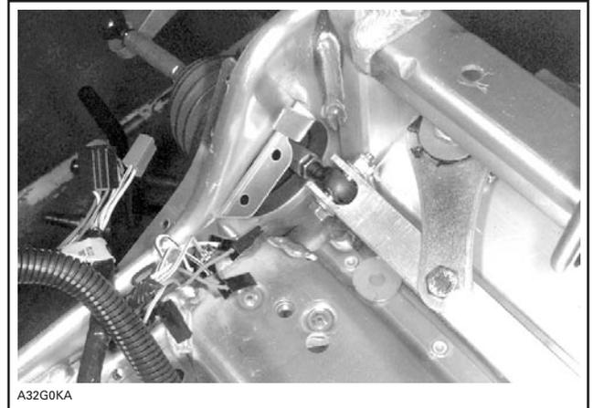
JOINT À ROTULE DE BARRE D'ACCOUPEMENT PARALLÈLE À LA BARRE OSCILLANTE AVANT DE SERRER
