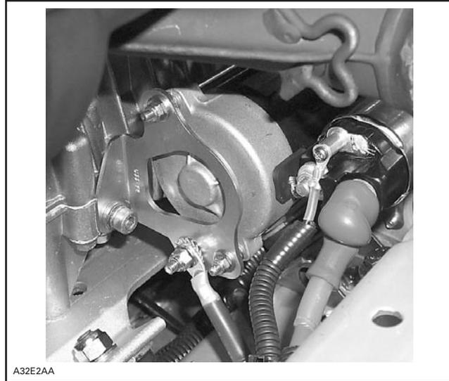
S'assurer que les surfaces de contact du moteur et du démarreur sont bien propres. De graves problèmes peuvent se présenter si le démarreur est mal aligné.
