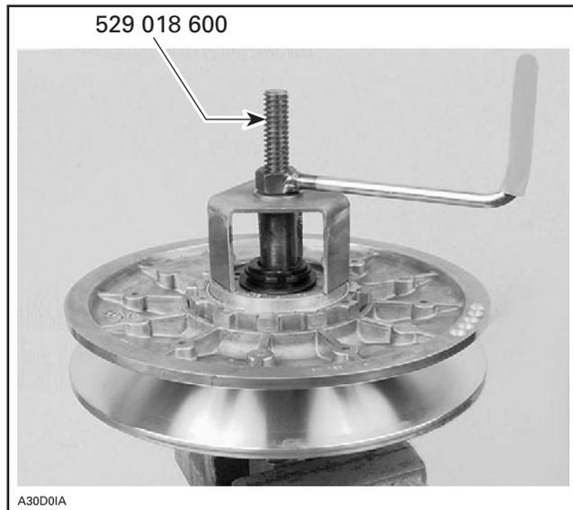
Enlever le circlip n° 3 et la rondelle n° 4 pour démonter la came et les 2 demi-poulies.
