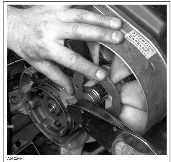
**SERRER L'ÉCROU DU VENTILATEUR AU MOYEN DE LA CLÉ DE RETENUE**
