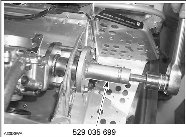
Installer l'extracteur (N/P 529 035 699) sur l'arbre de renvoi pour retirer complètement le roulement.
