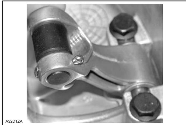
Installer les leviers (complets) pour que les goupilles fendues soient du bon côté (voir l'illustration). De plus, installer la tête des goupilles sur le dessus lorsque le levier est au bas de la demi-poulie coulissante. Replier l'extrémité des goupilles de sorte qu'elle repose parfaitement contre le levier.
