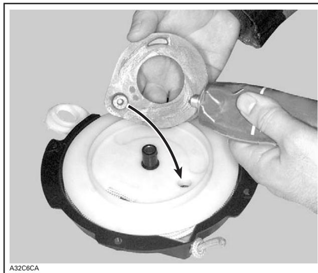
Lubrifier l'arrêt de cliquet n° 9 avec de la pâte PG 54 Molykote (N/P 420 899 763). L'installer par-dessus le cliquet.
