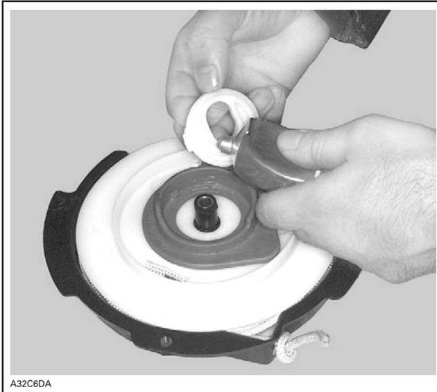
Installer le col à cran n° 10 en commençant par son manchon. Lubrifier le nouveau joint torique n° 11 et l'élément de blocage n° 9 avec de la pâte PG 54 Molykote (N/P 420 899 763). Installer le tout par-dessus l'arrêt de cliquet.
