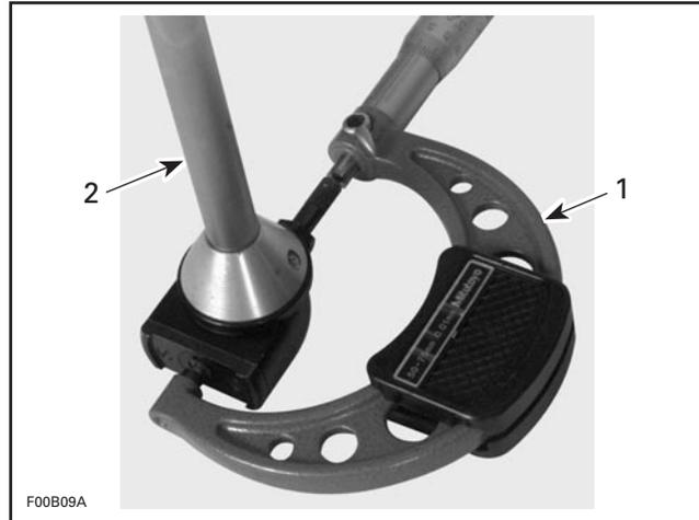
1. Utiliser le micromètre dans le but de régler la jauge d'alésage de cylindre
