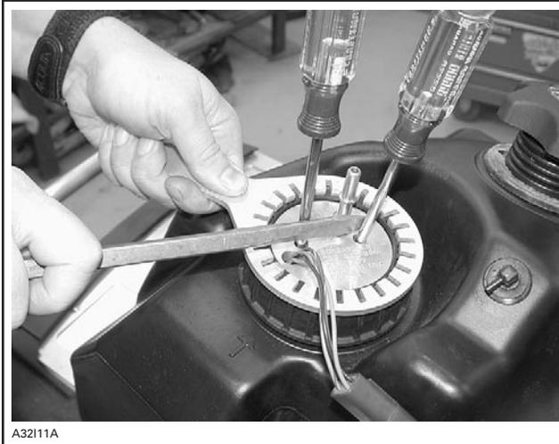
Sortir le module de pompe du réservoir pour exposer le corps de la sonde. Retirer le dispositif de retenue du corps de la sonde et retirer le flotteur (complet).
