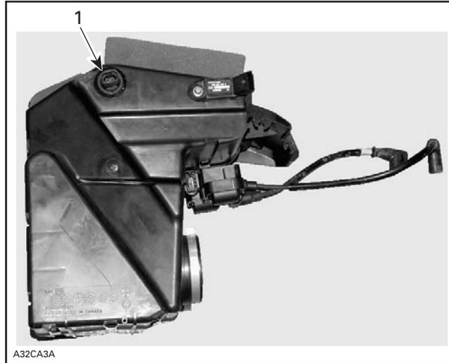
1. Sonde de température d'air (STA)
