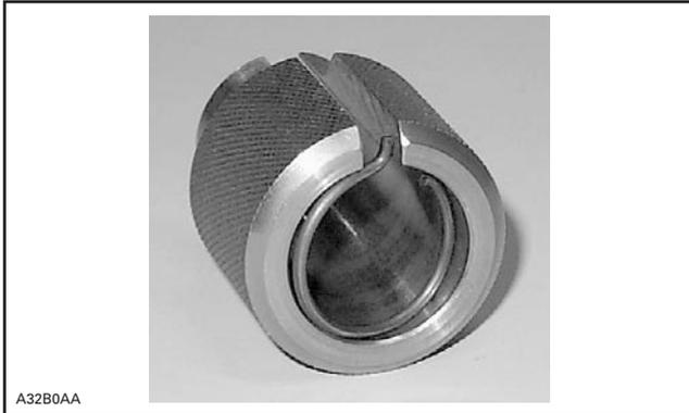
À l'aide de l'extrémité ronde du poussoir, placer le circlip perpendiculairement à l'axe du support.
