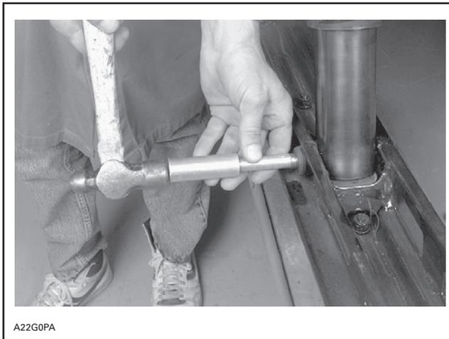
Desserrer l'écrou de la tige et retirer l'amortisseur par le bas. Vérifier l'amortisseur de la façon décrite dans la partie intitulée **INSPECTION**. Au moment de l'installation, s'assurer que les coussinets sont bien en place.
