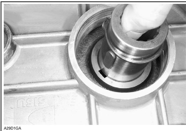
Appliquer de la graisse synthétique (N/P 413 711 500) sur les joints toriques des arbres intermédiaires.
