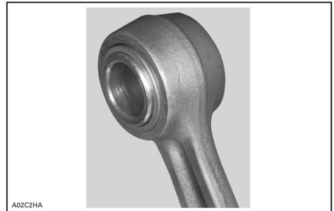
**TYPIQUE — ROULEMENT À AIGUILLES SANS CAGE ET MANCHON INSTALLÉS**
