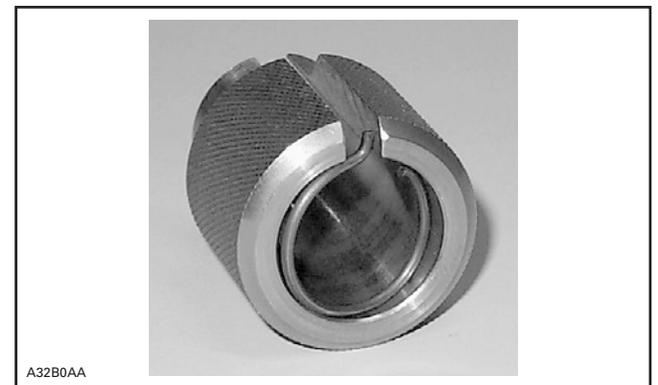
À l'aide de l'extrémité ronde du poussoir, placer le circlip perpendiculairement à l'axe du support.
