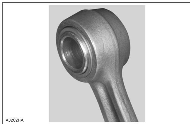
TYPIQUE — ROULEMENT À AIGUILLES SANS CAGE ET MANCHON INSTALLÉS
