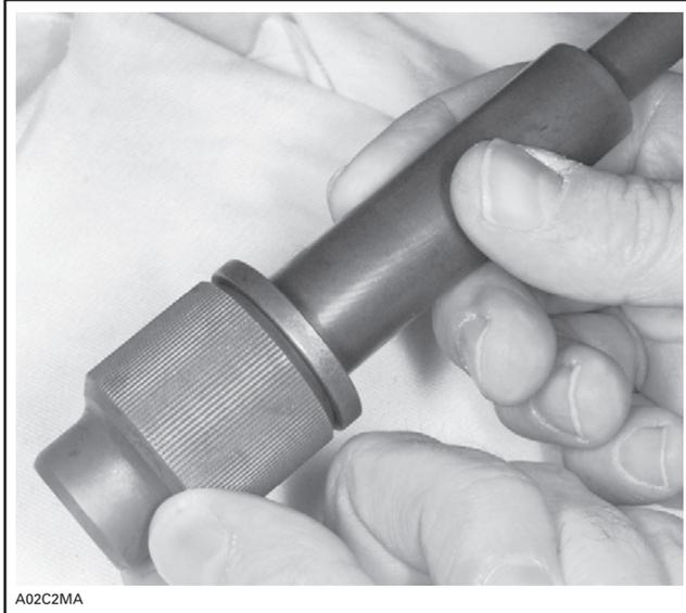
Exercer une pression sur le circlip avec l'extrémité carrée de l'outil jusqu'à ce qu'il prenne place dans la rainure.
