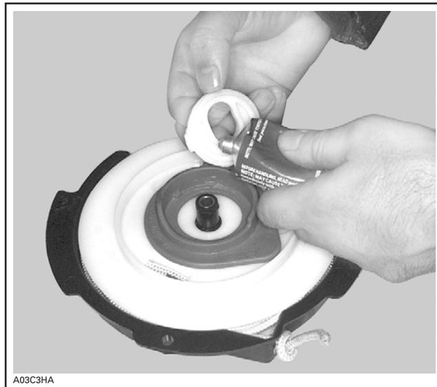
Installer le col à cran n° 10 en commençant par son manchon. Lubrifier le nouveau joint torique n° 11 et l'élément de blocage n° 9 avec du Molykote PG 54 (N/P 420 899 763). Installer le tout par-dessus l'arrêt de cliquet.
