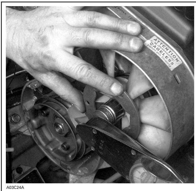
TORQUE FAN NUT USING FAN HOLDER TOOL
