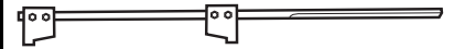
Alignment bar A) (P/N 529 025 600) B) (P/N 529 028 200) C) (P/N 529 028 300) D) (P/N 529 026 800) E) (P/N 529 031 000)
